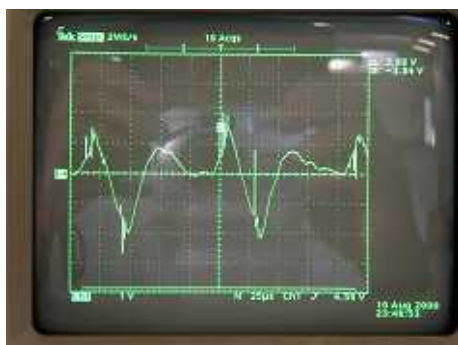
(図6) 図4の放電波形
